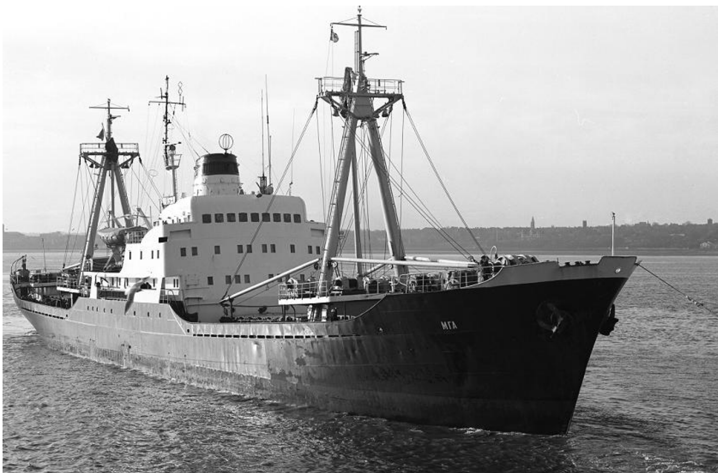
MGA, IMO 5233779, 1960 opgeleverd Schiffswerft "Neptun", Rostock () als MGA aan U.S.S.R., thuishaven: Tallinn. Roepsein UFHQ. 3.358 BRT, 1.738 NRT, 4.319 DWT. 103,99 (95,71) 14,41 x 7,90 x 6,560 meter. G 5.916 m 3 , B 5.635 m 3 . 242 ton bunkers, 12,5 kn. 2.500 EPK, 1.865 kW, 2 x 8 cyl, 4 tew, 365 x 550, vertraagd naar 1 schroef, Görlitzer Maschinenbau, Görlitz. Later opnieuw gemeten: 3.145 BRT, 1,628 NRT, 4.388 DWT. 10-9-1986 gearriveerd Gadani Beach om gesloopt te worden. (Foto NN-T. v.d. Zee, 11-1979).
