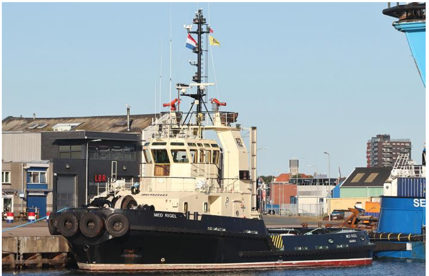
MED RIGEL, IMO 9525443, Pusher/Tug, 20-12-2007 contract, 30-9-2009 kiel gelegd, 25-6-2010 bouw gereed, 1-7-2010 opgeleverd door Astilleros Armon S.A. (689) als VEHINTICINCO aan Remolques Unidos SL, Spanje. 428 GT, 128 NT, 413 DWT, 5.978 EPK, 4.400 kW, 2 x 16 cyl, 4 tew, 170 x 215, 1.800 rpm., vertraagd naar 225 rpm., Caterpillar 3516C-HD, Caterpillar Inc., Indiana NE-09. 2-2011 verkocht aan Santander Lease S.A., EFC, Spanje, in beheer bij Remolques Unidos SL. 5-2022 verkocht aan Narrativa Basilar Unipessoal, Madeira-Portugal (CQQZ). 14-6-2022 herdoopt MED RIGEL. 26-7-2022 te Rotterdam. 31-7-2022 te IJmuiden. (Foto: Jan Plug, 1-8-2022, IJmuiden).
